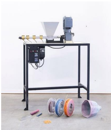
Abb. 1: Hakkens Maschine zum Recyceln von Plastik
