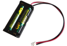
Batterie für externe Strom- versorgung des micro:bits (3V)
